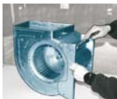
Montar las patas B sobre el ventilador colocando los topes de caucho (antivibratorios) C.
