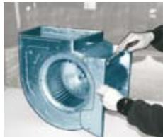
Montar las patas B sobre el ventilador colocando los topes de caucho (antivibradores) C.
